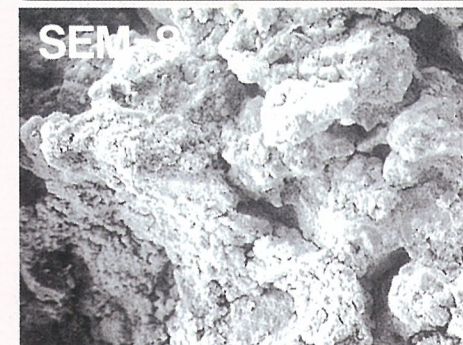
SEM-8 現場コア(SEM-7資料) (×600) SEM-7で観察される鉱物が、鉄加水酸化物であるかを識別するための鉄成分の面分析画面(SEM-9)と対応する資料の形状画面。
